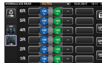
フロントとリアの油圧バルブ、フロントとリアのリンケージ、フロントローダーなど、あらゆる油圧機能を操作するためのコントロールを割り当てることができます。
