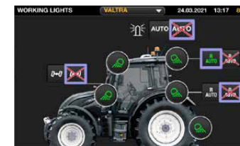
9インチのタッチスクリーンで作業用ライトを簡単に構成できます。PremiumおよびPremium+作業用ライトには設定可能も含まれています フロントアクスルのホイール角度センサーによって制御されるコーナリングライト。
