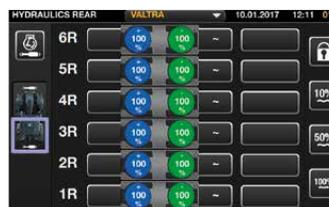
フロントとリアの油圧バルブ、フロントとリアのリンクエージ、フロントローダーなど、油圧機能を操作するためのコントロールを割り当てることができます。
