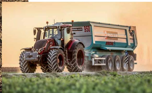
Valtra Direct、Versu、およびActiveモデルは、115または160 l / minの油圧ポンプを備えた大容量の荷検知油圧を提供します。特別な場合には、200 l / minでも選択できます。トランスミッションと油圧用に別々のオイルがあり、後部に最大7つのサービスバルブ、前部に4つのバルブがあります。VersuおよびDirectモデルでは、すべてのバルブは、SmartTouchユーザーインターフェイスを使用した電子制御で完全に調整可能です。アクティブモデルとハイテックモデルでは、リア
