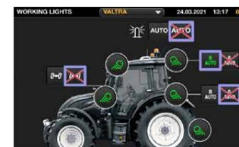
9インチのタッチスクリーンで作業灯を簡単に構成できます。プレミアムおよびプレミアム+ワークライトには設定可能も含まれています。フロントアクスルのホイール角度センサーによって制御されるコーナリングライト。
